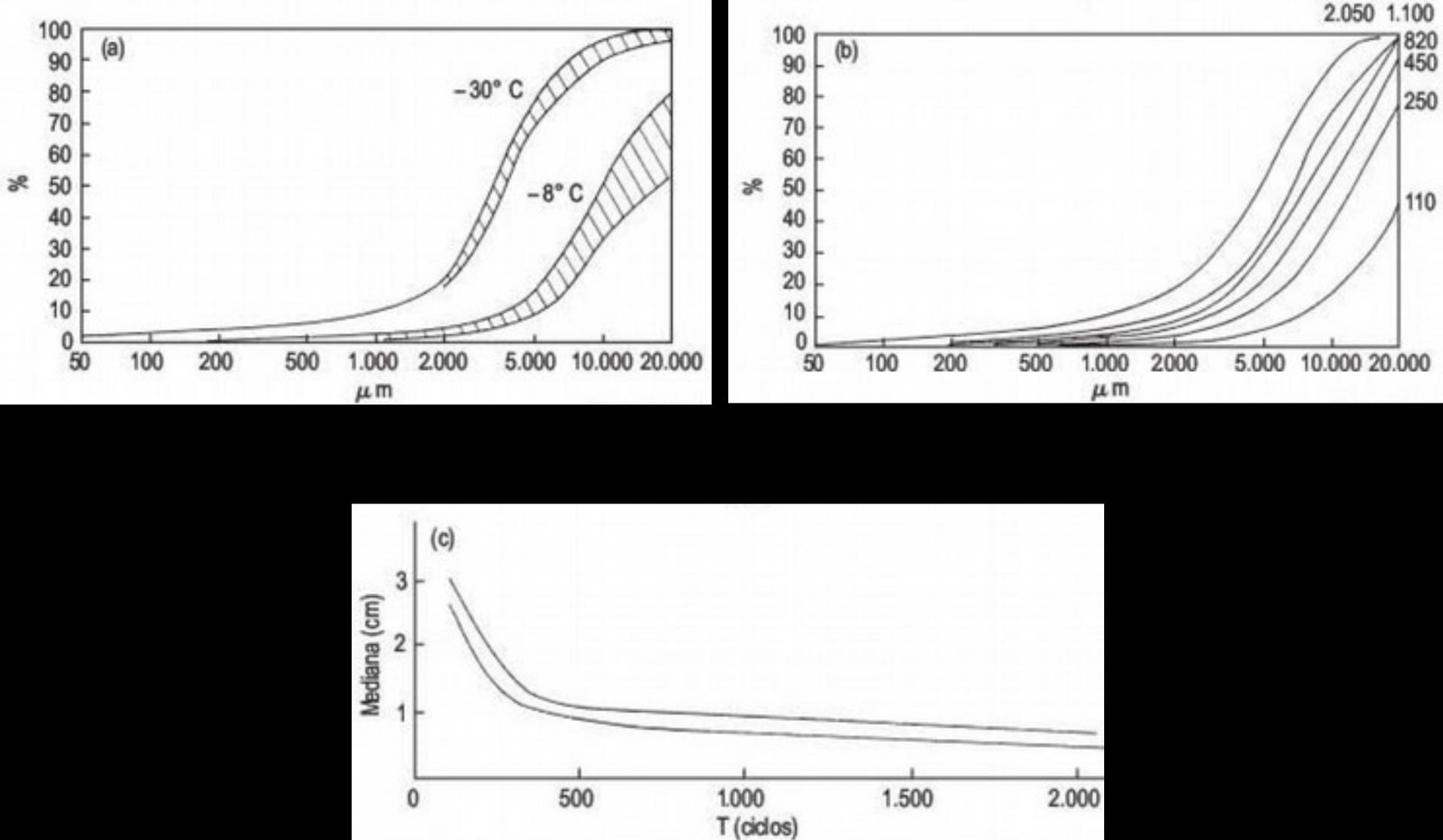
**FIGURA 5.8** Ejemplos de granulometrías de gelifractos resultantes de esquistos precámbricos de Normandía. (a) Influencia de la intensidad de la helada. (b) Cambio con el tiempo (indicado por el número de ciclos de helada a  $-18^\circ\text{C}$ ). (c) Reducción con el tiempo de la mediana de los gelifractos (ciclos de helada a  $-8^\circ\text{C}$ ) para las muestras B y F (modificado de Lautridou, 1988).
